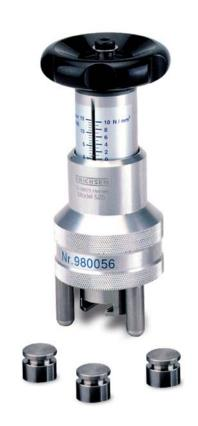
Il est à noter que cette méthode de mesure de l'adhérence donne des résultats qui ne sont généralement pas directement comparables aux résultats d'autres méthodes : la procédure d'essai de coupe transversale exerce principalement des forces de cisaillement sur le revêtement alors que la force exercée par le modèle 525 agit perpendiculairement à la surface.
